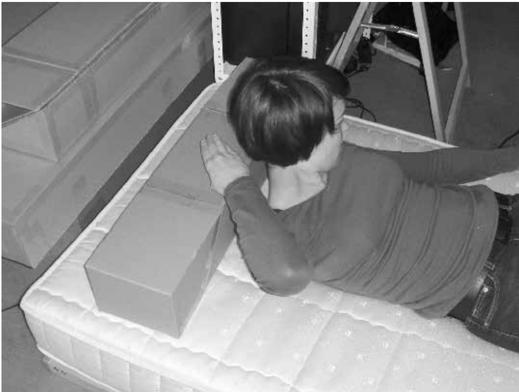
links: 1:1-Vormodell aus Wellpappe als erste Variante oben: ergonomische Untersuchung des Vormodells
